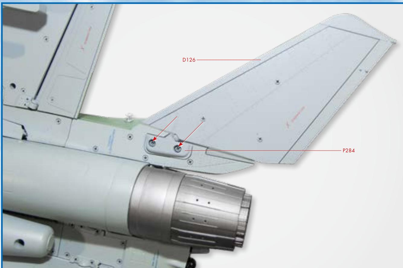
**2** Вставьте ось стабилизатора в гнездо фюзеляжа, затем установите крепежную планку (P284), как показано на снимке, и зафиксируйте ее винтами LM. Проверьте подвижность стабилизатора.
