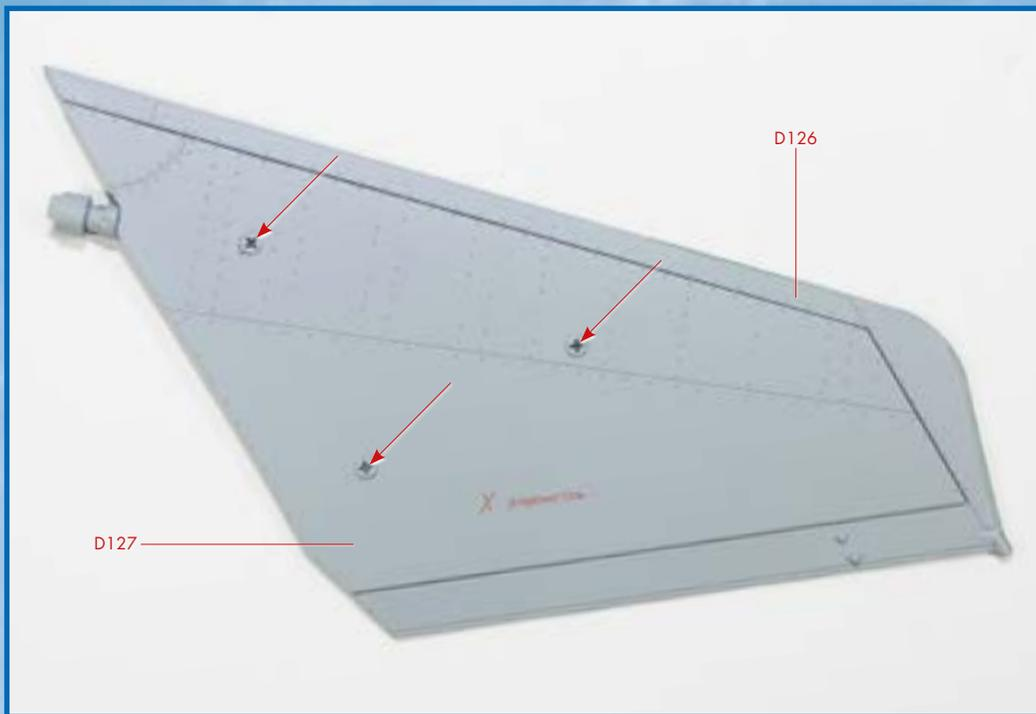
**1** На этом этапе сборки вам потребуются детали, полученные с этим номером, и узел деталей из № 109. Соедините верхнюю часть стабилизатора (D126) с нижней частью стабилизатора (D127), как показано на снимке, и зафиксируйте детали винтами SM.
